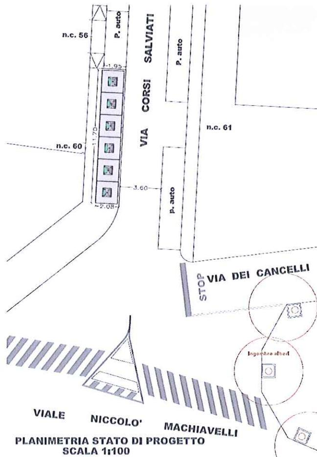
Figura 13: Planimetria di progetto della postazione interrattata da realizzare in viale Machiavelli (incrocio con via Salviati).
