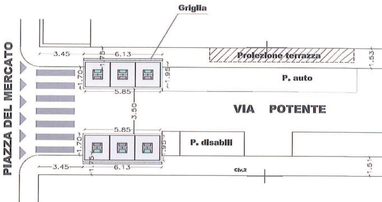
Figura 4: Planimetria di progetto della postazione interrata da realizzare in via Potente (incrocio con P.zza del Mercato).
